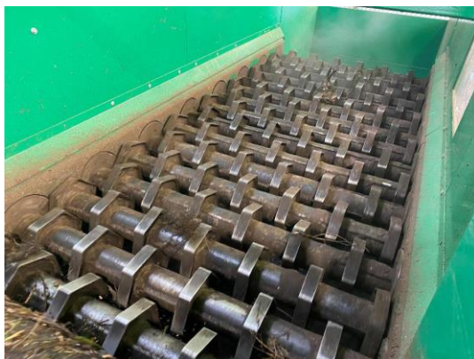
Bild 3-1: Scheibensieb der Fa. Neuenhauser (MBA Freienhufen)
