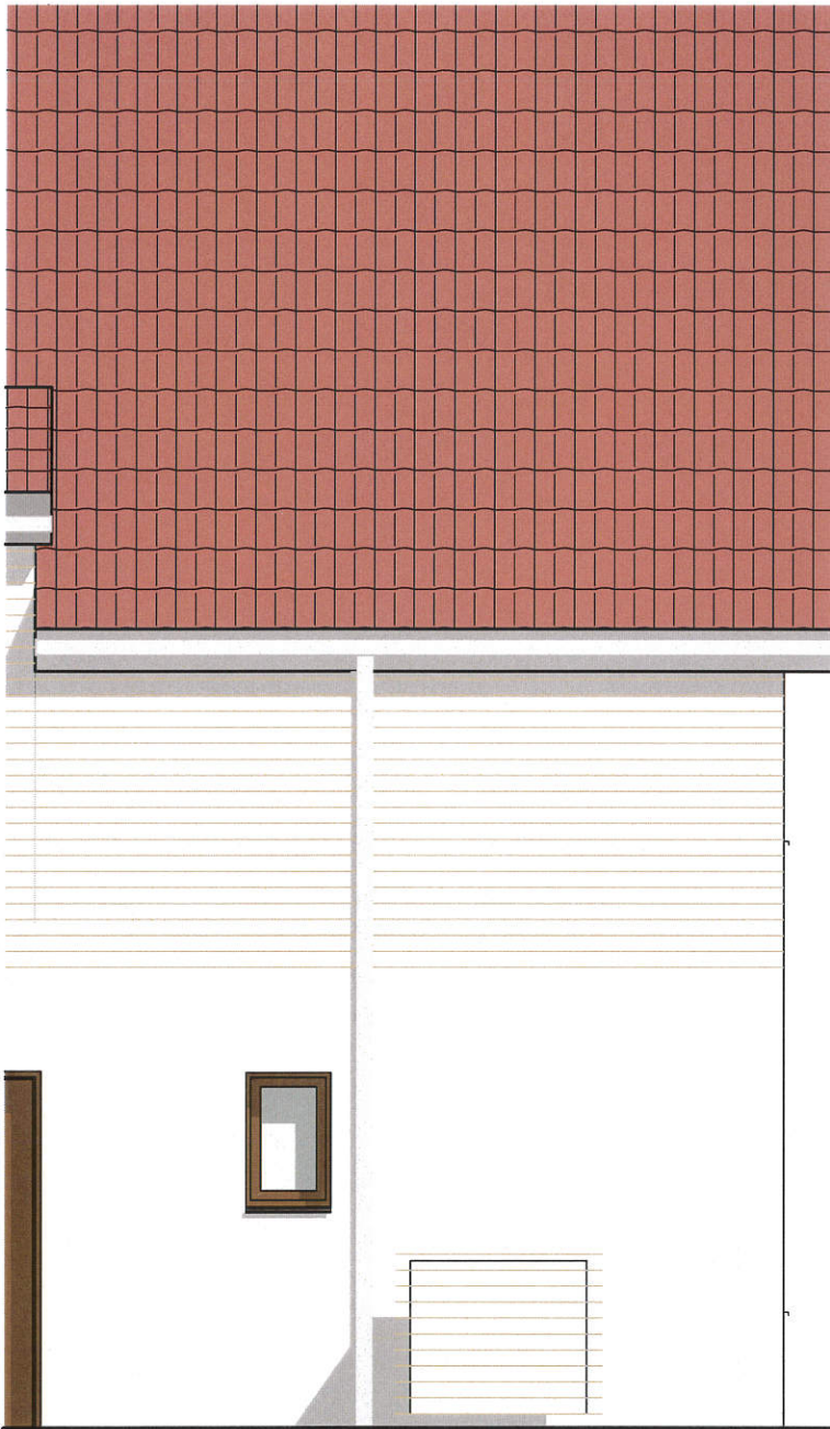
Verkleidung der Außeneinheiten von Luft-Wärmepumpen mit einer Holzverschalung, horizontal, Lärche natur oder Metallblech, lackiert in gebrochenem Weiß (Beispiel im Bild oben)
